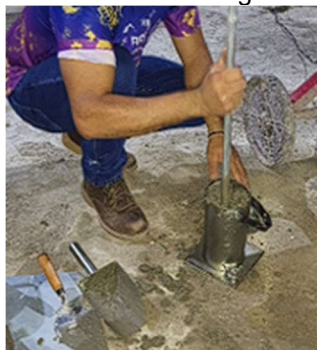
a) Preenchimento com 2 camadas e 12 golpes
