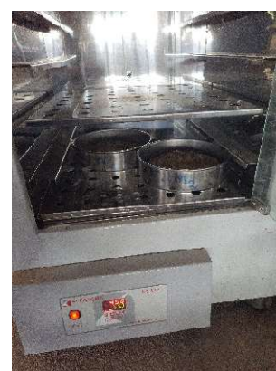
c) Secagem das amostras em estufa
