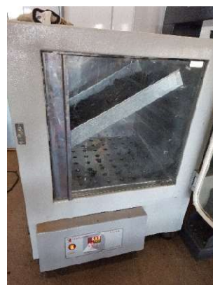
b) Secagem do agregado graúdo em estufa
