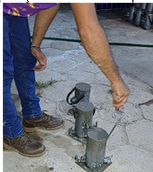
b) Rasamento da superfície
