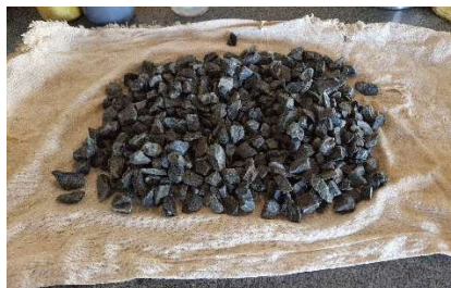
a) Brita na condição saturada superfície seca
