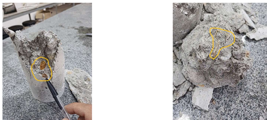
a) Identificação de grãos de argila no interior do CP
