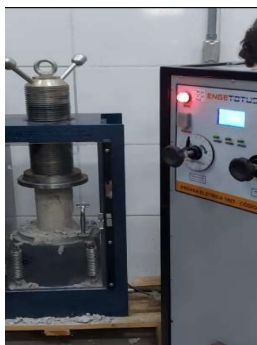
Figura 4 – Prensa hidráulica fazendo ensaio de resistência em corpo de prova
