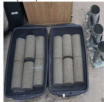
c) CP's em cura após a desforma
