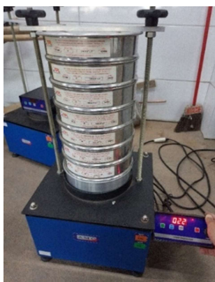
Figura 7 – Peneiras sobre o agitador mecânico durante o ensaio.
