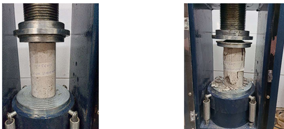
a) Posicionamento do CP no equipamento de ensaio
