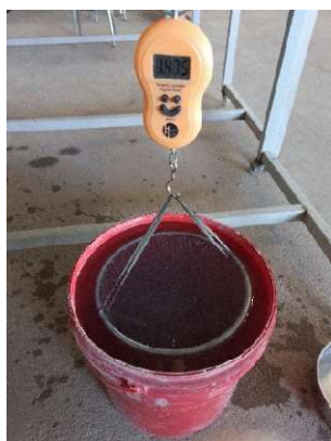
a) Pesagem através do cesto de arame imerso em água.
