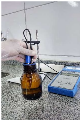
Figura 25 – Aferição do pH da água de amassamento.
